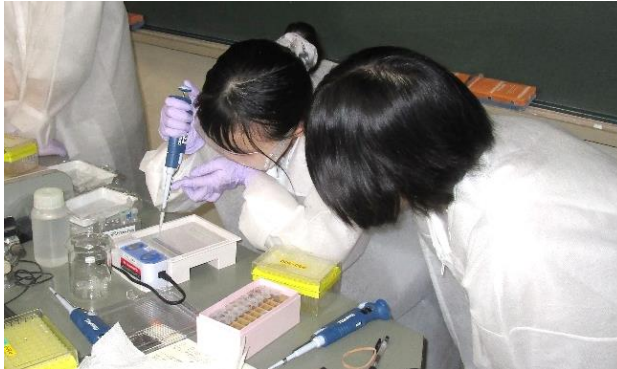
電気泳動装置にPCRで増幅したDNA溶液を入れる生徒
